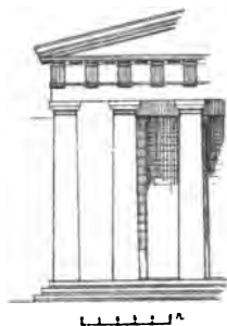
187. — L'architrave de la cella et celle du naos. Temple de Némée. Élévation partielle.
